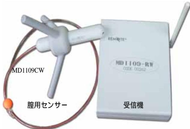
図1 体温遠隔監視装置
