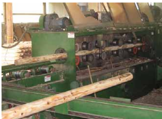
間伐材の円柱加工機による丸棒形成
