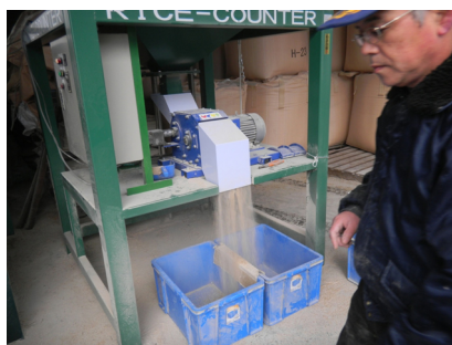
配電盤内部のスイッチを入れ、破碎開始
