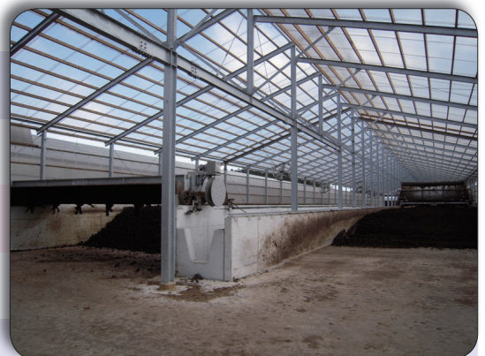
▲発酵糞乾施設 糞尿は効率的に処理できるようになり、乾燥した戻し堆肥は敷き料として利用
