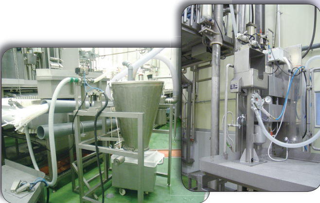
▲BSE 対策のための近代的機械類（硬膜除去装置、せき髄吸引機）
