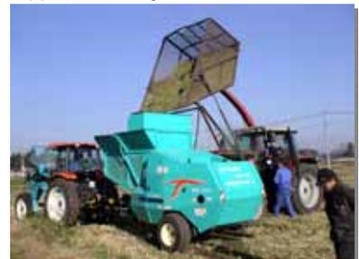
人手によるサイロ詰め作業から作業者を解放し、従来体系に比較して大幅な省力化を実現。
