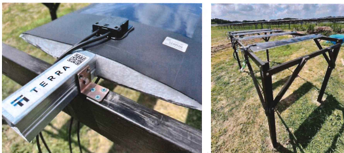
写真 9 ソーラーシェアリング用の架台に設置したフィルム型ペロブスカイトの試作品
