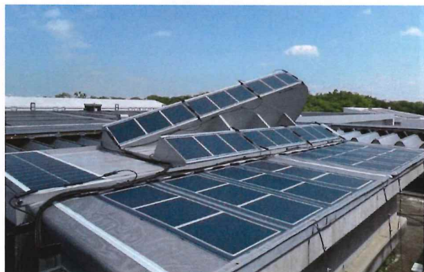
写真 13 「ファスナー取り外し式工法」の実証実験の様子 ファスナーでシートを連結(左)、ファスナーでシートの両端を固定(右)
