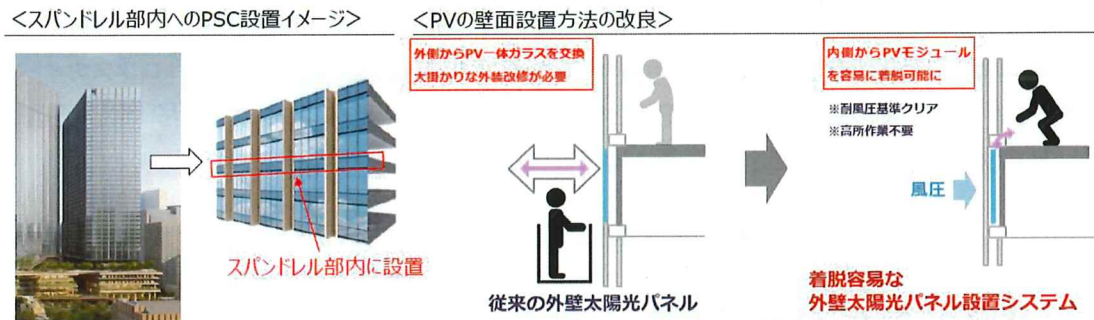
図3 スパンドレル部の内部にペロブスカイト太陽電池を設置
