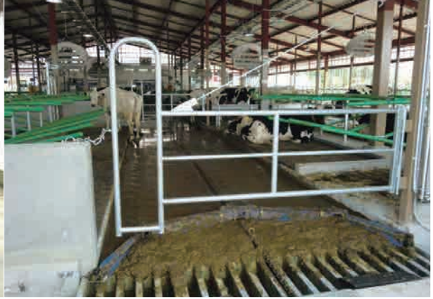
チェーン式スクレーパーによる自動除糞
