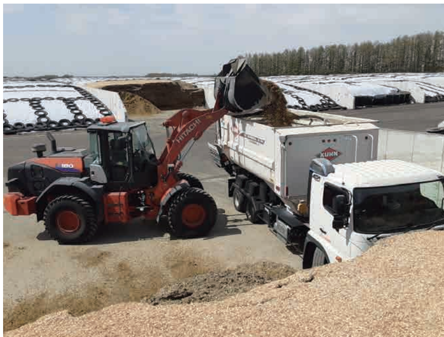
積み込み作業
