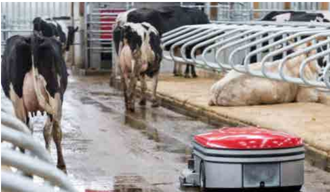
図16 スクレーパーロボット Lely社 出典:Lely社 ホームページより
