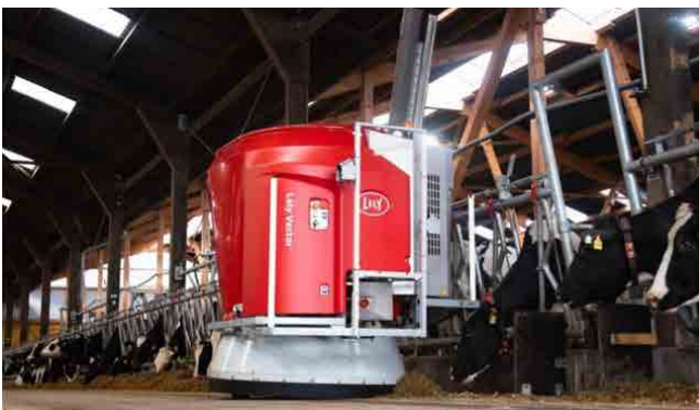
図4 自動給餌器 Lely社:Vector 出典:コーン・エージー ホームページより
