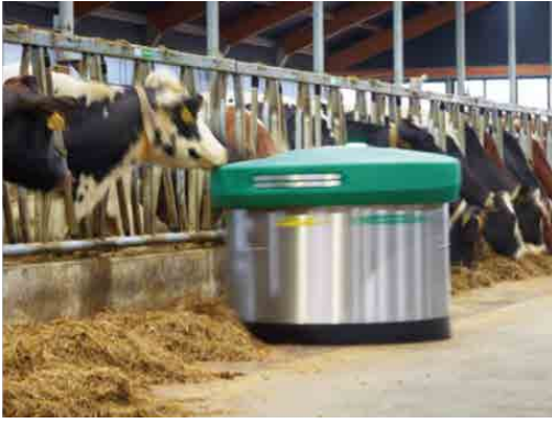
図6 餌寄せロボット オリオン機械(株):Moov 2.0 出典:オリオン機械(株) ホームページより
