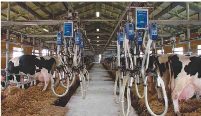
図12 繁飼い用キャリボ オリオン機械(株):UCA30A 出典:オリオン機械(株) ホームページより
