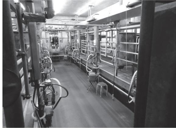
(写真3) オートタンデム型ミルクパーラー(4頭W)
