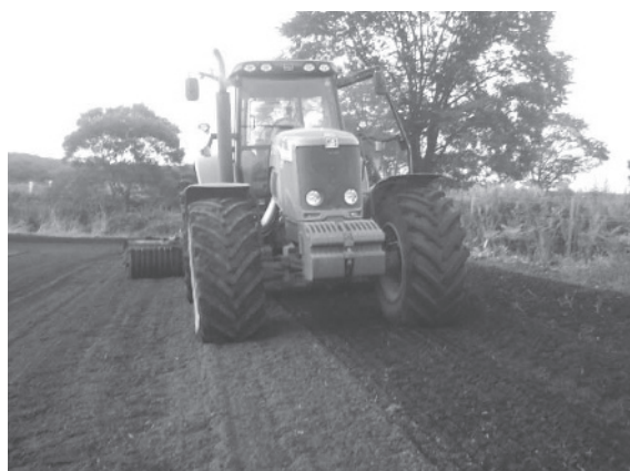
(写真4) 鎮圧ローラーの半分重ね掛け
