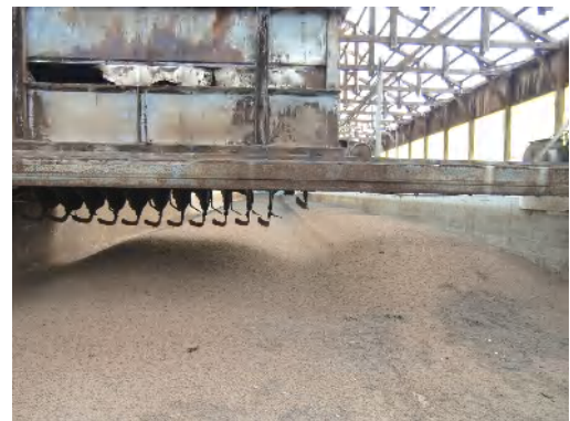
第一次発酵では鶏糞を約45日間発酵させた後 第二次発酵施設へ移動させる。
