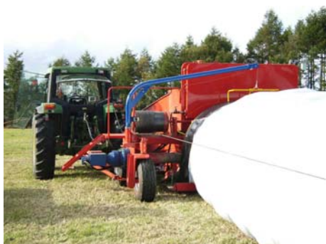
チューブバッグサイロ詰め作業風景
