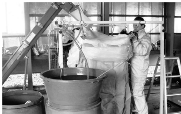
(写真4) フレコンバックへの詰め込み
