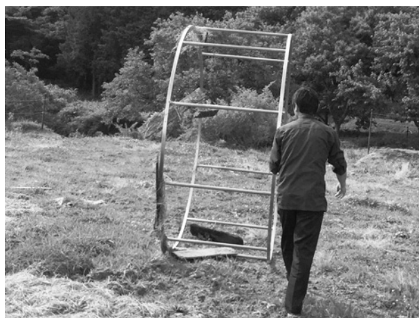
(写真9) らくらくきゅうじくん、転がして移動できる（農研機構開発）
