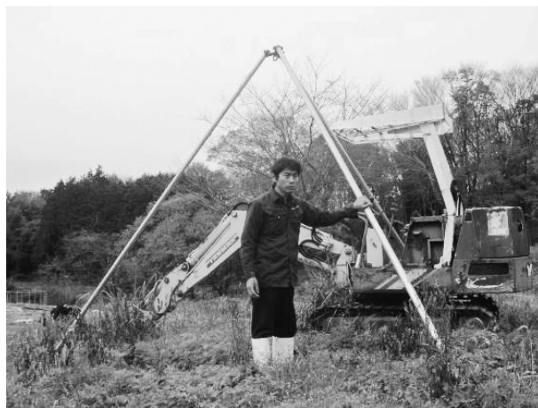
(写真10) ロールベール運搬用チェーンブロック三脚（中央は益子さん）
