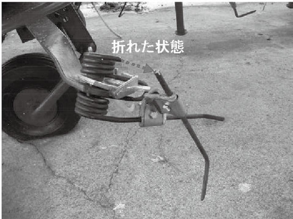
写真1 タインが折れても脱落しない様子
