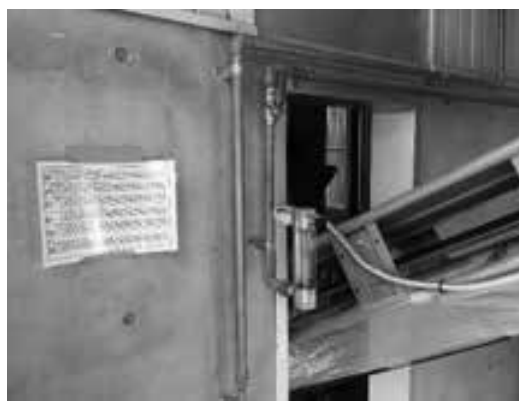
(写真15)流量調整弁付き流量計と加水率設定早見表
