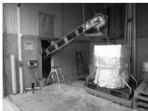
(写真13)梱包作業はフロアスケールで計量しながら加水と同時に行なう
