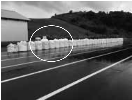
(写真2) 試作試験○で囲んだ5個だけが膨らんでいる。
