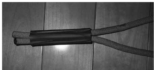
（写真2）ホースを入れ込んだところ
