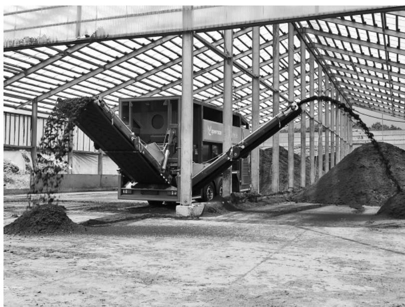
堆肥選別の様子。副資材（左）と細粒選別した堆肥（右）に選別される
