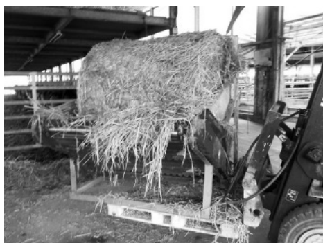
フォークリフトのロールほぐし機
