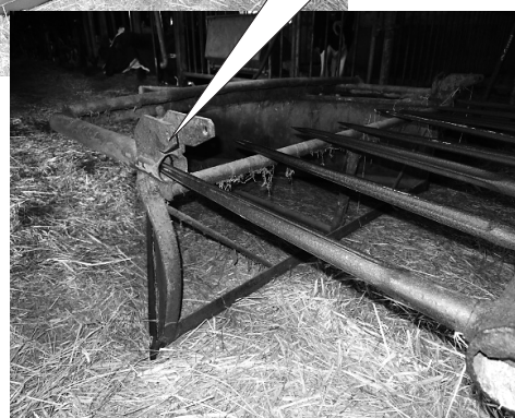
現在のエサ押し機械 ※マニアホークの爪を差し込む
