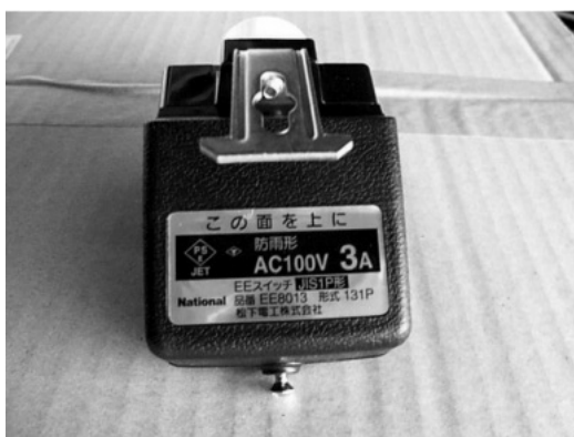
（写真7）街路灯用自動点灯器具
