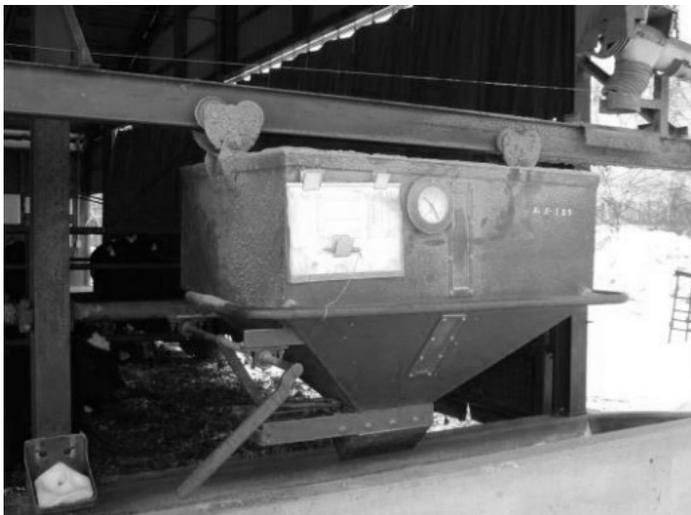
(写真1) タイマーによる配合飼料投入量の計測と記録
