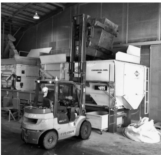
写真2 TMRミキサーによる食品循環資源の混合 (回転フォークリフトによる投入)
