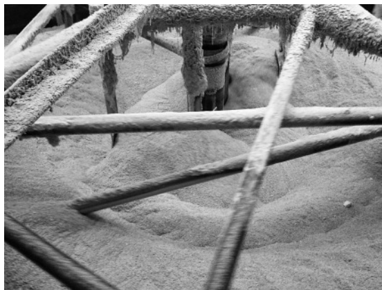
写真8 攪拌機による混合
