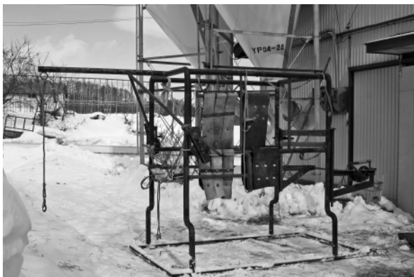
(写真2) 桜庭さんが製作した削蹄枠（牛が入る前）
