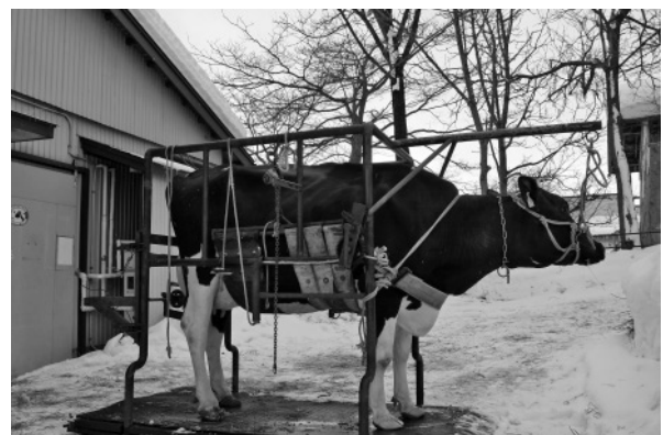
(写真3) 桜庭さんが製作した削蹄枠（牛を固定した状態）
