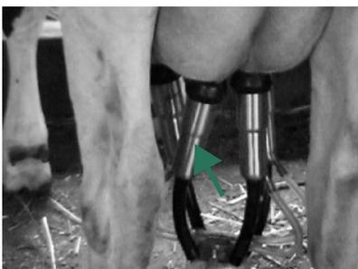
(写真16) ミルクチューブの取り扱いが悪くライナーが傾いている。
