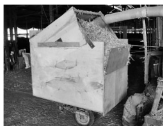
粗飼料専用の配餌車(改良型)
