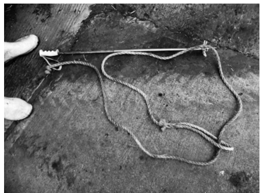
写真1 ストックの先に係留用のロープを引っ掛けるだけの簡単な作り
