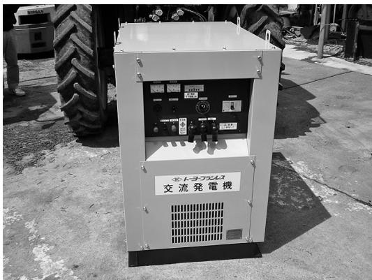
(写真1) PTO駆動交流発電機本体
