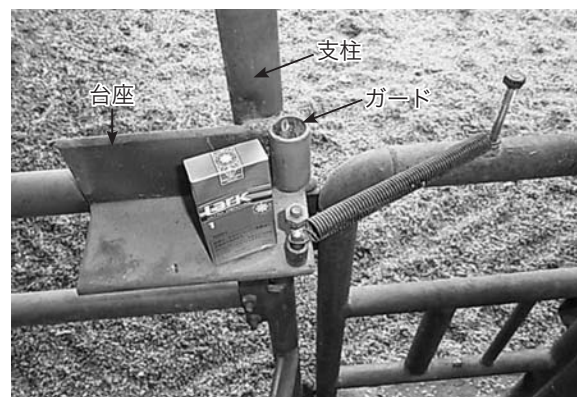
(写真1) 台座とスプリングの設置。直角三角形の形に取り付けます。扉を開けたときにスプリングの伸びがスムーズになるよう、丸い円柱をガードとして設けます。
