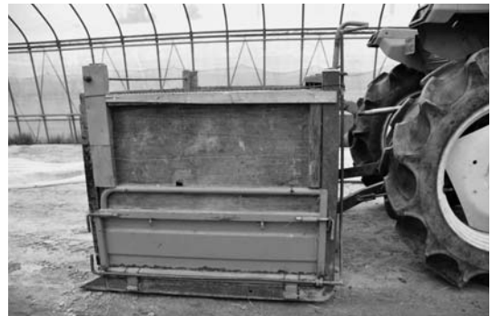
(写真1) 運搬機のサイズは、縦90cm横140cm 高さ75cm
