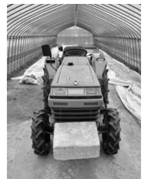
（写真7）コンクリートで作ったバランス用のおもり
