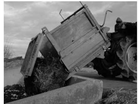
（写真6）トラクターの油圧で、排出は一瞬にできる
