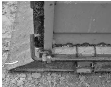
（写真5）排出ゲートを固定するレバー。ボルトを溶接して駆動部を作った
