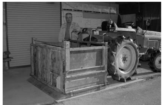
(写真2) 考案した「たい肥運搬機」とストップレバーを持つ奥山さん。レバーは左右にあり、後方のゲートの開きをおさえてたい肥の落下を防ぐ
