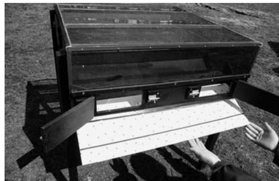
（写真2）ベニヤ板に粘着シートを固定し、ワンタッチで交換可能
