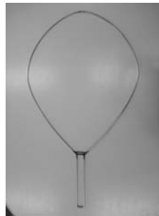
(写真1)直径3mmのステンレス棒の枠部分。 枠の部分はステンレス溶接が必要
