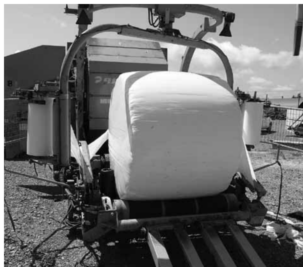
(写真3) 細断型のロールベアラによる高密度の発酵TMR
