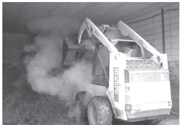
(写真 2) 通気型たい肥舎のローダーによる切り返し（たい肥化が促進している）
