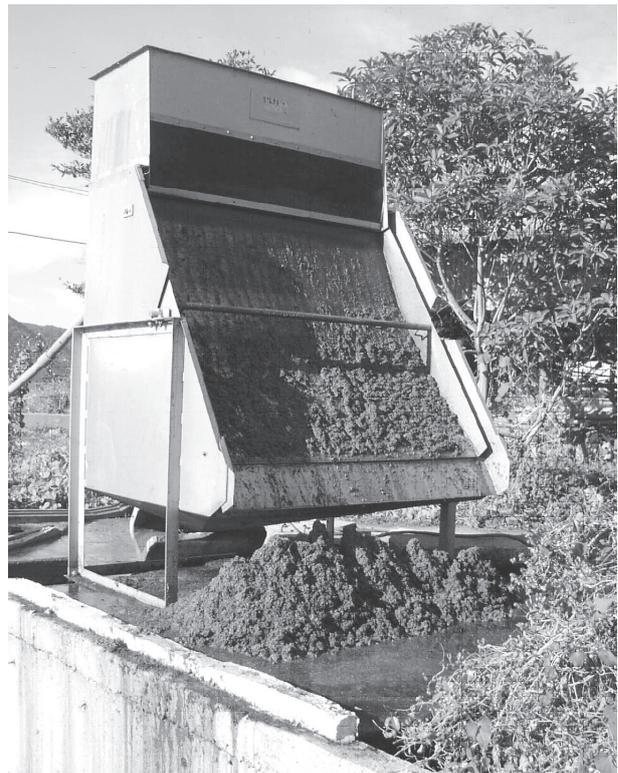
(写真3) 振動ふるい処理設備
