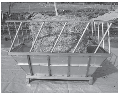
（写真①）畜産試験場が開発した草架（草架にロール乾草を挿入。採食ロス試験のためにシートを敷いています）
