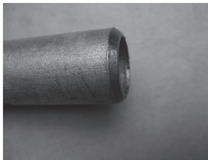
(写真3) ガス管先端部は丸く縁取りする
