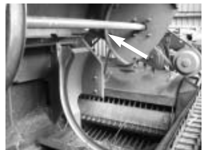
(写真3) こぎ胴を外した様子(シャフト部分は残します)
