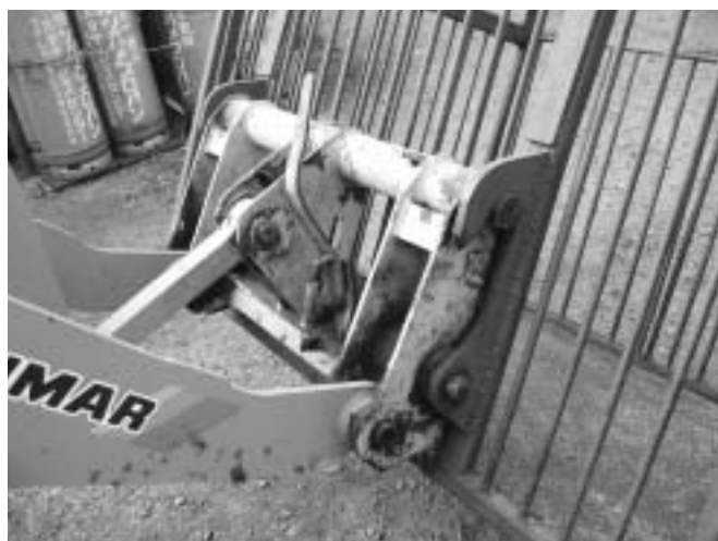
（写真1）運搬機をホイロローダに接続
