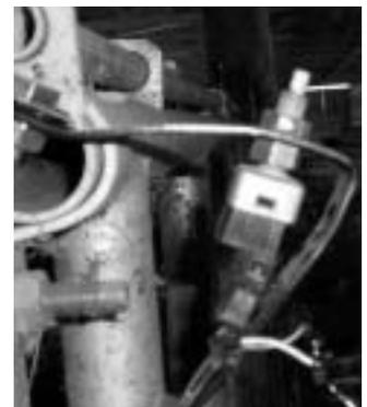
(写真4)自動車室内灯のスイッチで電流をカット
