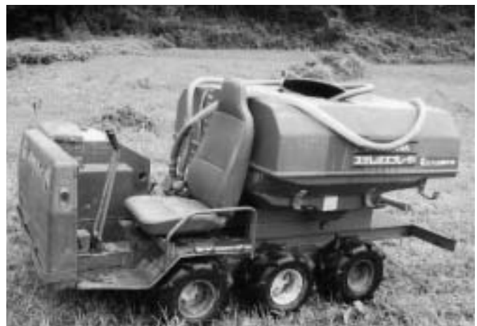
（写真1）改造した自走式尿バキューム・散布機
