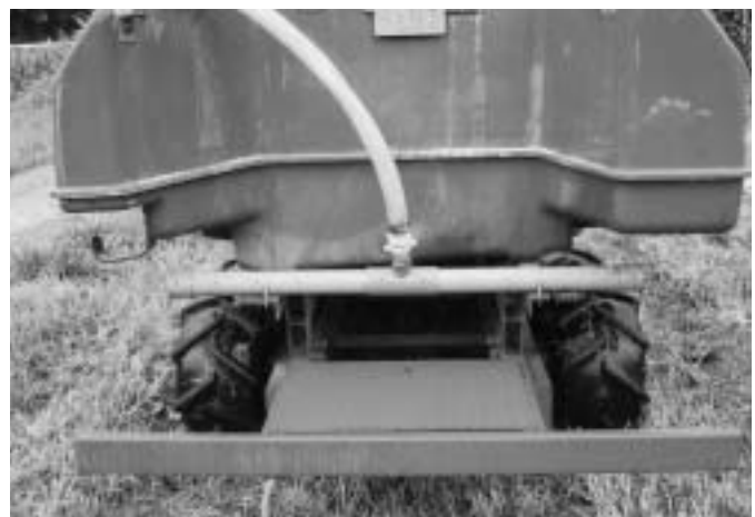
（写真2）塩ビパイプ製散布装置
