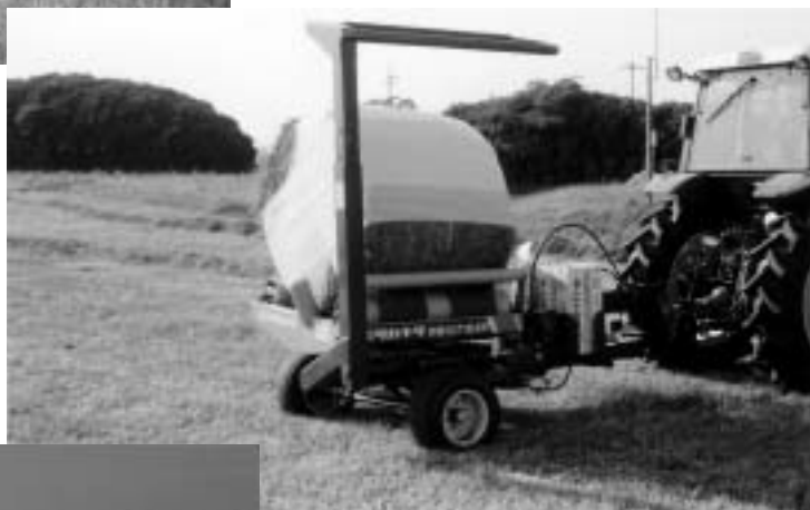
ラッピングマシンによるラッピング作業。
