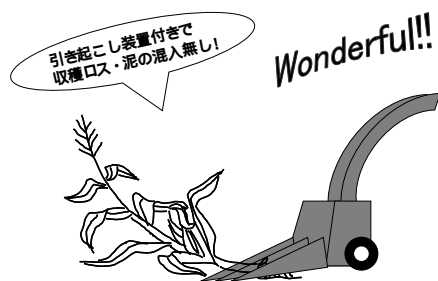
図-3 西に倒れたトウモロコシを南に向かって刈り取れば...!?
