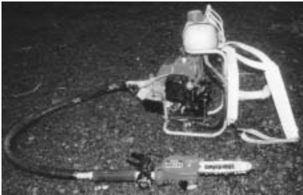
写真-4 枝切チェーンソーがあると、切り倒した木の枝をさらに切断でき、運搬が楽になる
