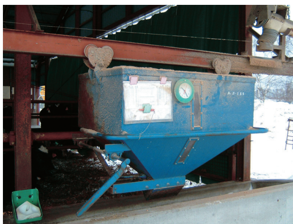
写真64 タイマーによる配合飼料投入量の計測と記録
