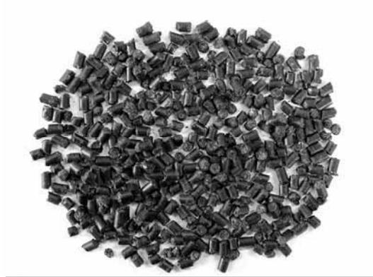
写真1 直径5mmの成型堆肥
