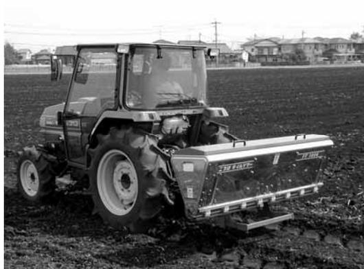
写真2 石灰散布機による散布作業
