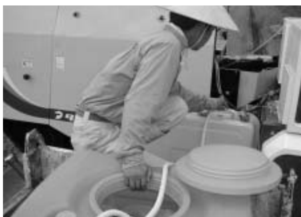
写真-8 その日に使うFJLBを100ℓ培養タンクから添加装置に注入する
