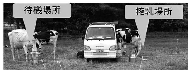
写真2 軽トラック型簡易的移動式搾乳機
